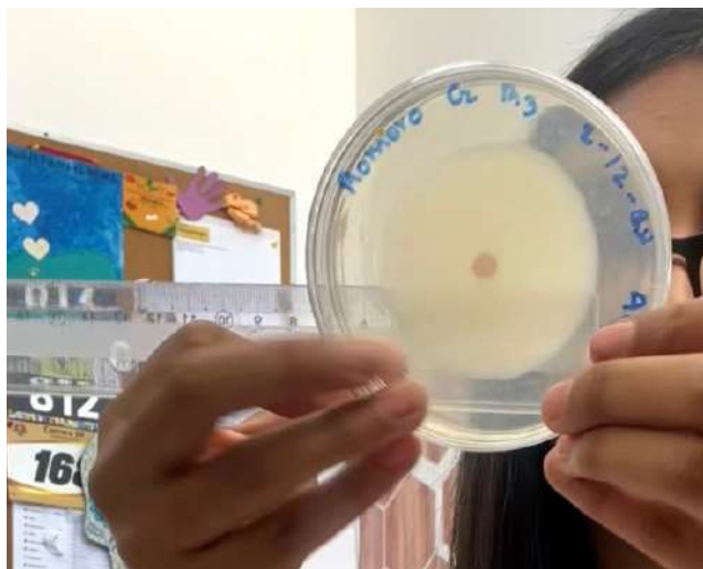
Imagen 5. Medición del crecimiento micelial diario con una regla.
