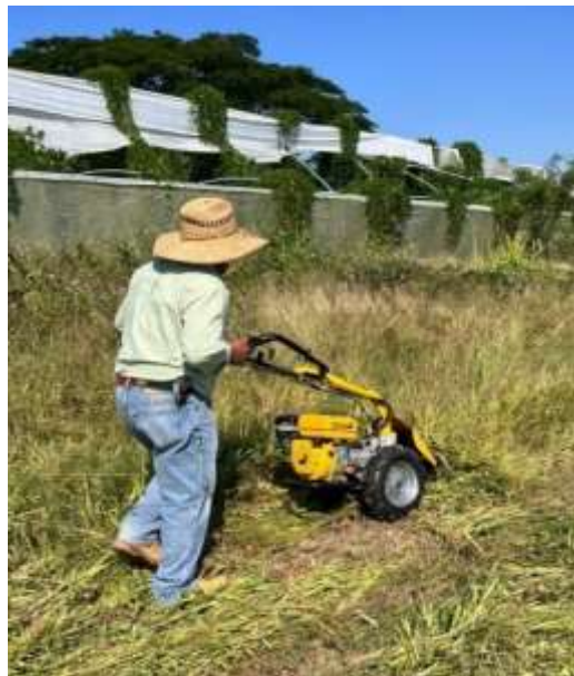
Figura 2.4 Control mecánico de arvenses con motocultor
