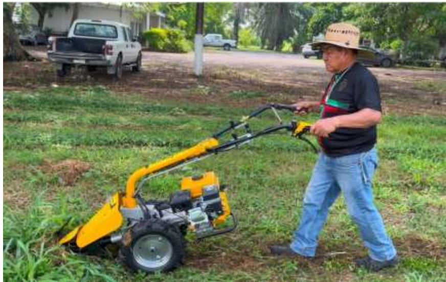
Figura 3.3 Prueba de velocidad con motocultor Parazzini.
