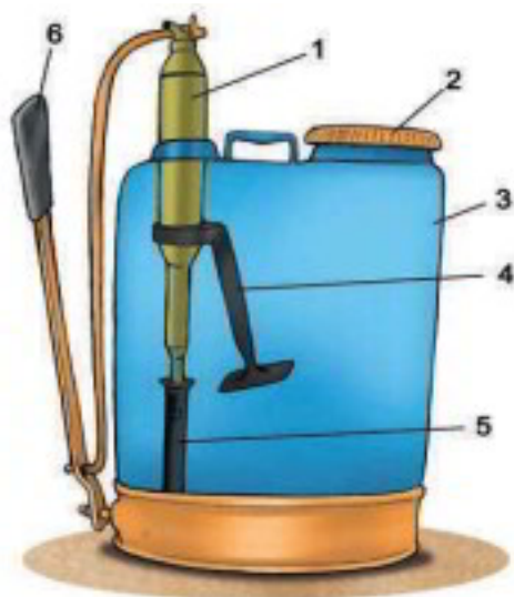
Figura 2.7 Partes de un equipo de espalda manual con sistema interno (autor: guías BPA)
