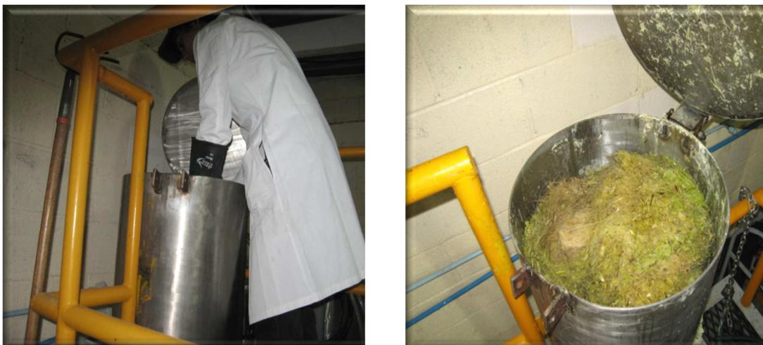
**Figura 8.** Prensado de guishe en prensa de acero inoxidable de 200 L.
