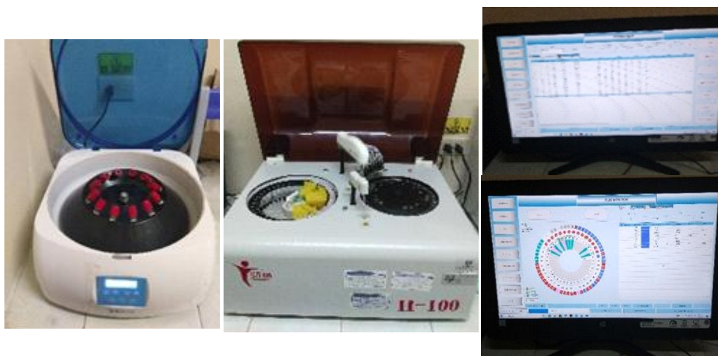
Figura 11. Análisis de metabolitos sanguíneos con el equipo H-100
