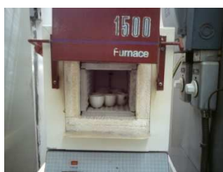
Figura 5. Mufla marca Thermolyne modelo 1500
