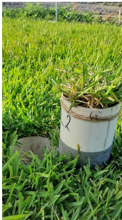
Figura 7. mini lisímetros de PVC; para medir la tasa de evapotranspiración diaria del pasto (por diferencia de peso de los mini lisímetros)
