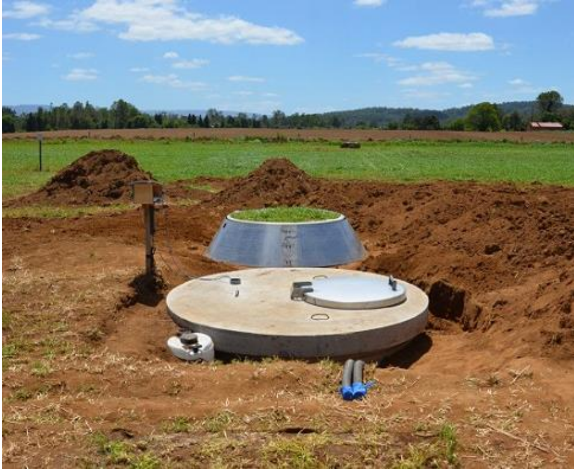
Figura 3. Implementación de un lisímetro de alta resolución para estudios de dinámica de agua y su eficiencia de uso en Andisoles bajo uso agrícola.
