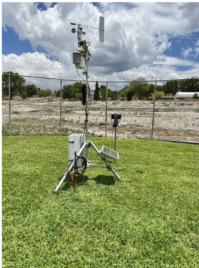
Figura 6. Estación meteorológica automatizada (Campbell Sic., Logan, Utah, USA) para obtener las variables meteorológicas, para la determinación de la evapotranspiración de referencia FAO Penman-Monteith.
