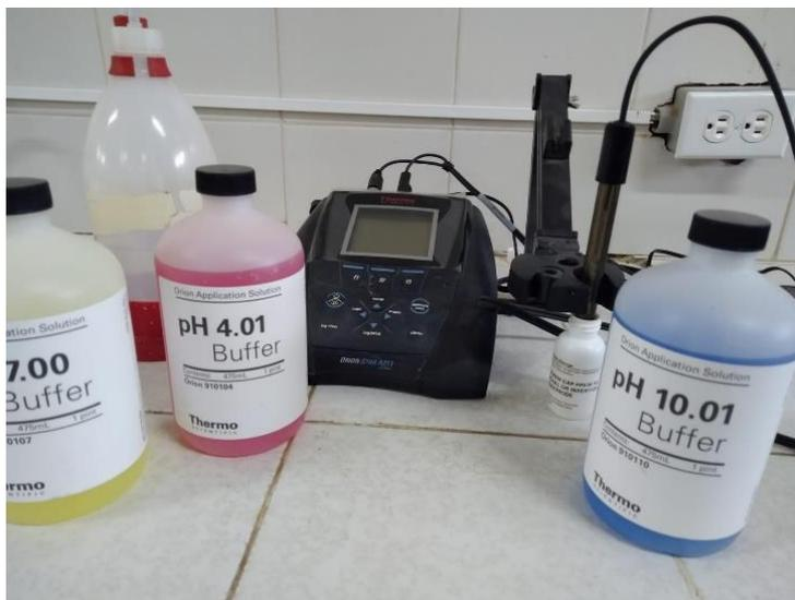
**Ilustración 9** Potenciómetro y soluciones de Buffer para medir pH
