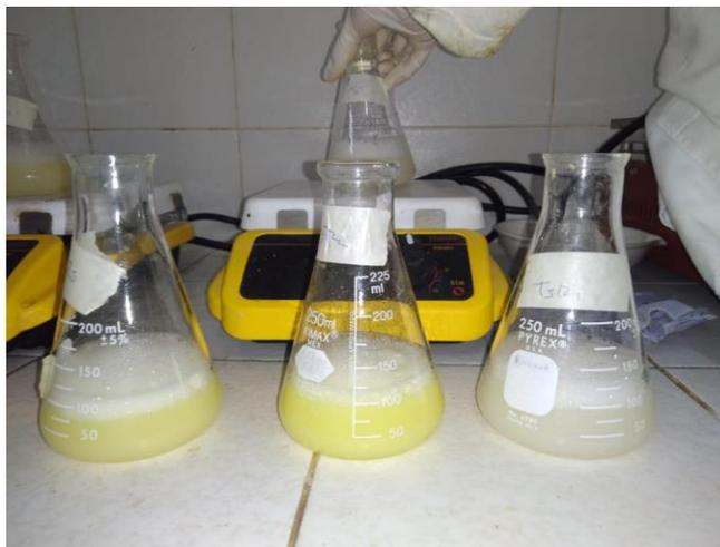
**Ilustración 16** Diluciones para determinar cloruros
