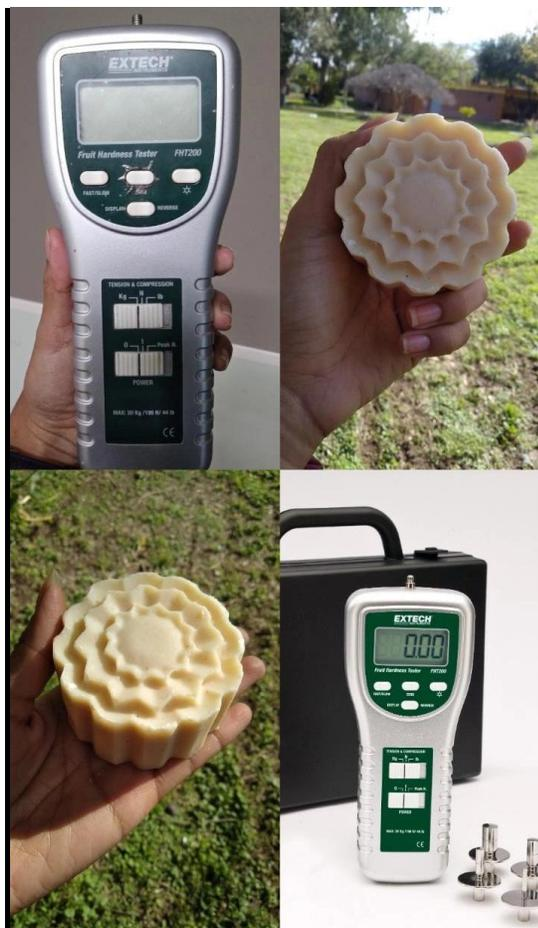
**Ilustración 6** Equipo utilizado para la prueba de dureza.
