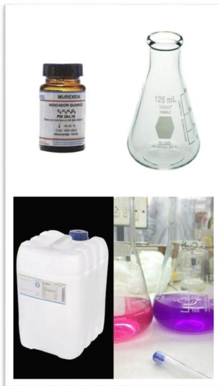
**Ilustración 13** Material para determinación de Cloruros en prueba de espuma.
