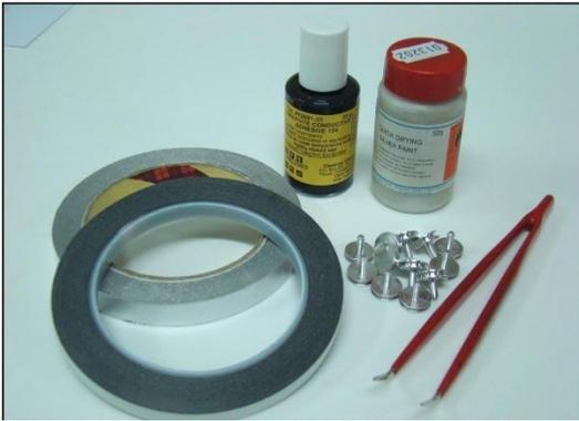
Figura 9: Preparación la muestra para análisis con SEM/EDX.
