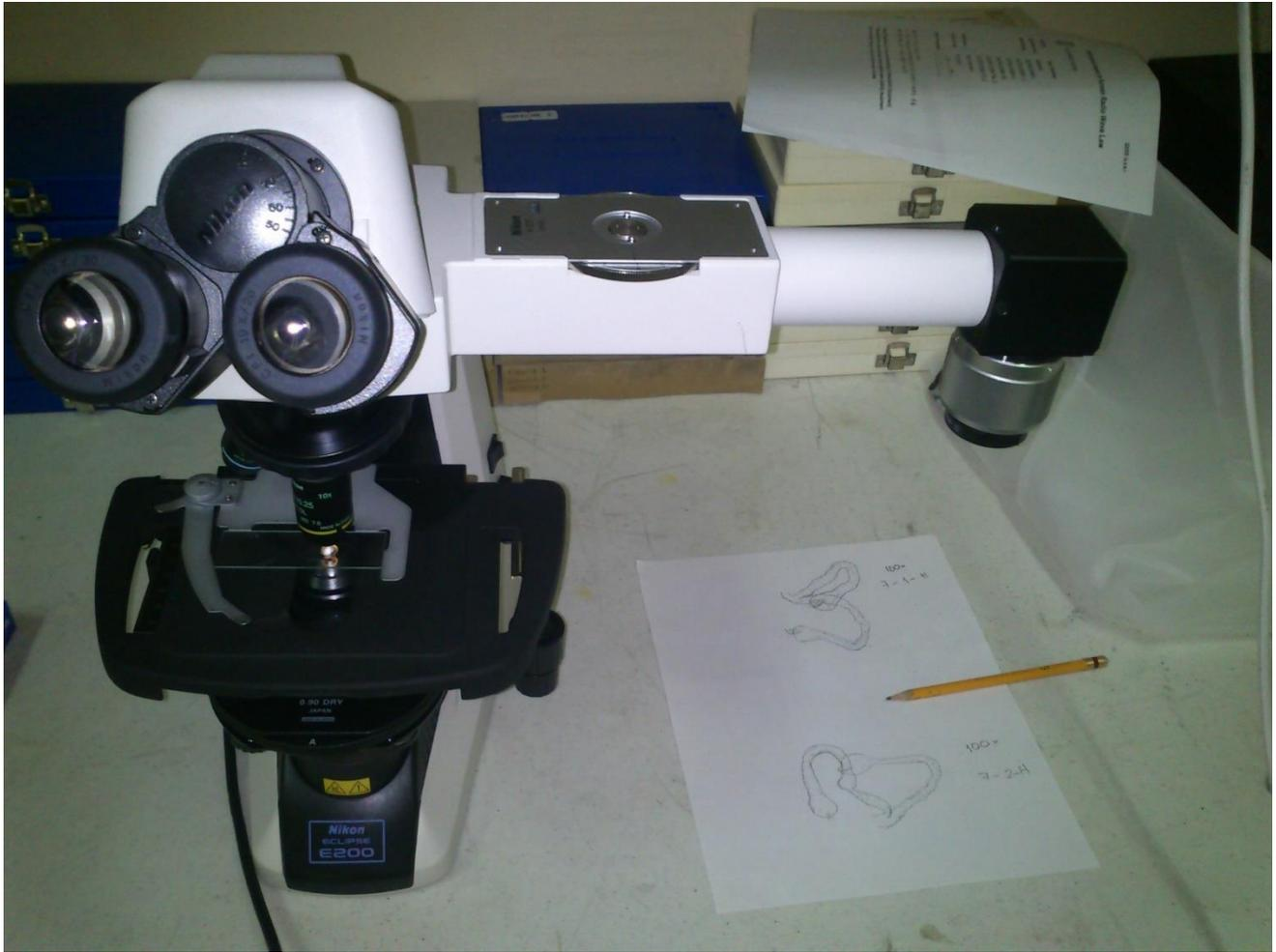
Figura 20. Microscopio Nikon Eclipse E200, cámara clara que sirvió para realizar los diagramas de las espermotecas de *Lutzomyia*.
