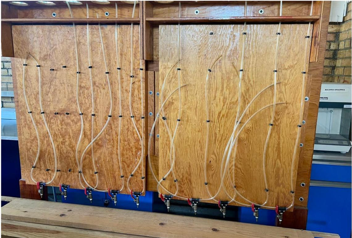
**Figura 1.** Banco de pruebas para determinar la relación entre el volumen de agua extraído del sustrato para diferentes valores de tensión aplicada.
