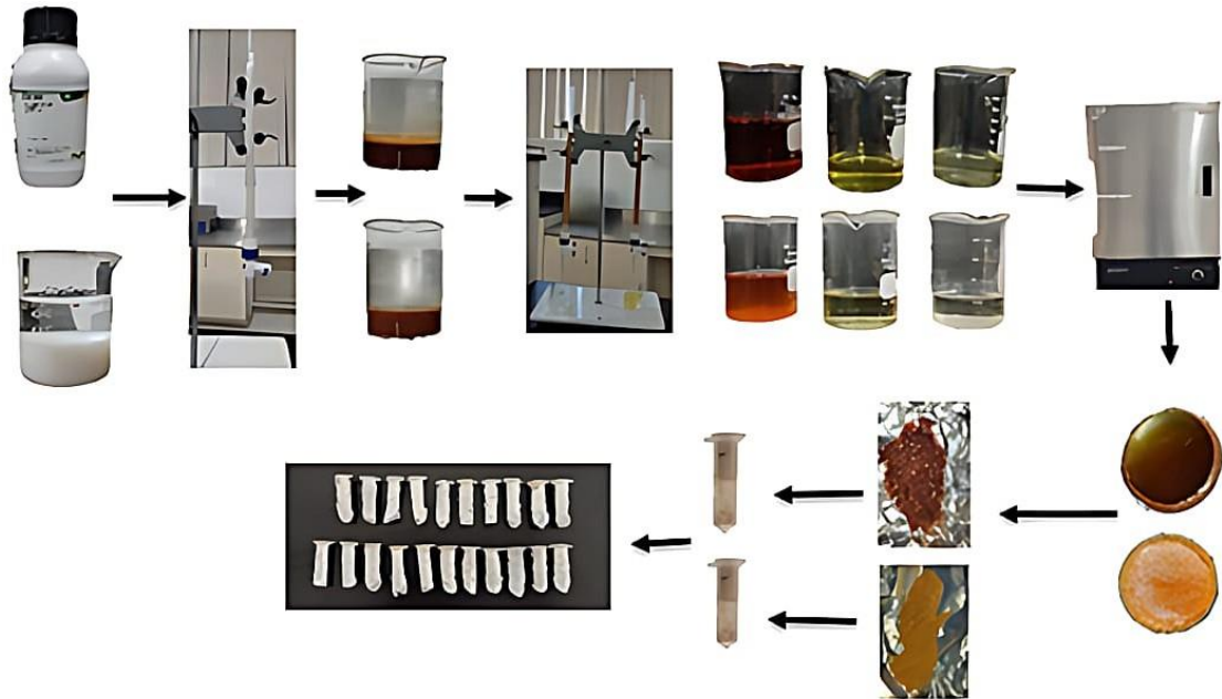
Figura 20. Extracción de polifenoles mediante cromatografía en columna.
