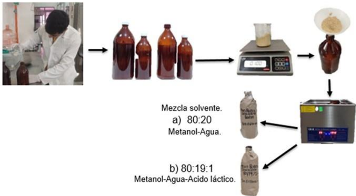
Figura 17. Extracción mediante maceración a) 80:20 metanol-agua y b) 80:19:1 metanol: agua: ácido láctico.
