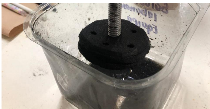
Figura 1. Diseño de la agrupación de electrodos empleada en el reactor unitario
