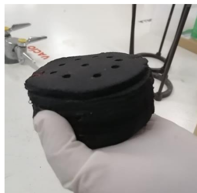
Figura 1. Diseño de la agrupación de electrodos empleada en el reactor unitario
