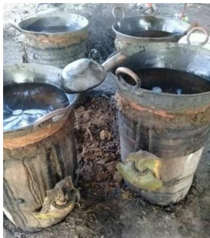
Figura 24. Destilador de Captación Interna “Campanilla”
