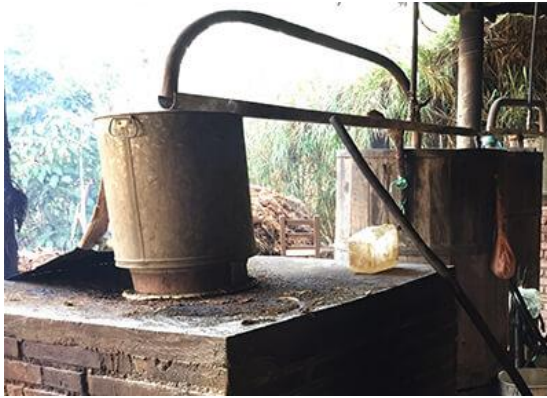
Figura 25. Destilador con Refrescadera (Belaunzarán, 2020).
