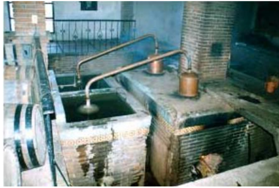
Figura 23. Alambique instalado para la Producción de Mezcal (Ramales y Ortiz, 2006).
