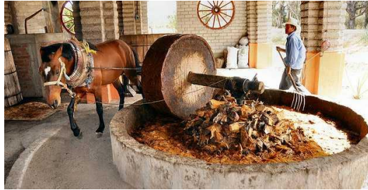
Figura 19. Molienda de Agave en Molino de Piedra (Regeneración-Administrador, 2014).
