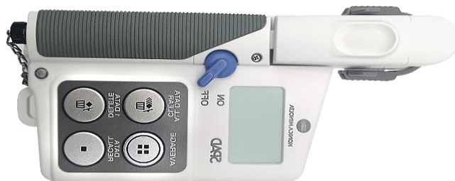
Figura 5. Medidor de clorofila de la marca Minolta 502 Plus
