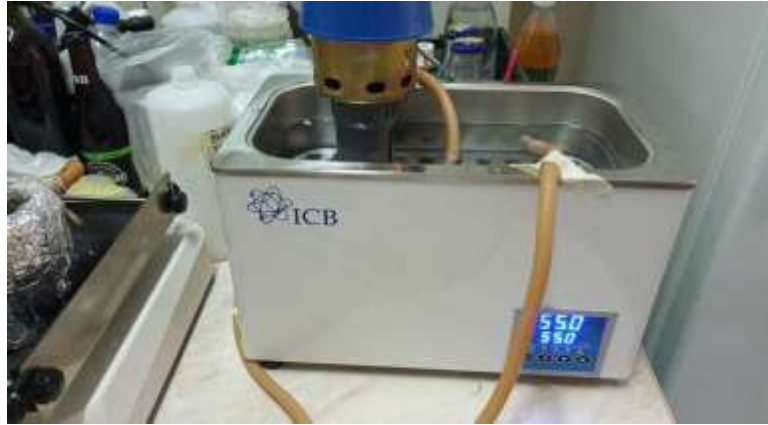
Figura 15. Baño María y bomba de recirculación
