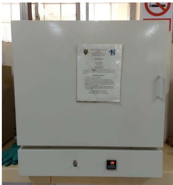
Figura 6. Estufa marca "Felisa" utilizada para la obtención de materia seca en plántulas de jitomate
