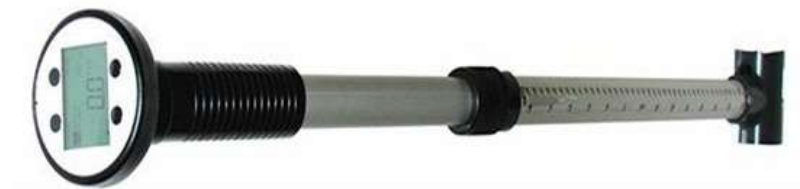
Ilustración 11. Instrumento De Alta Precisión Para Medir La Velocidad Del Agua
