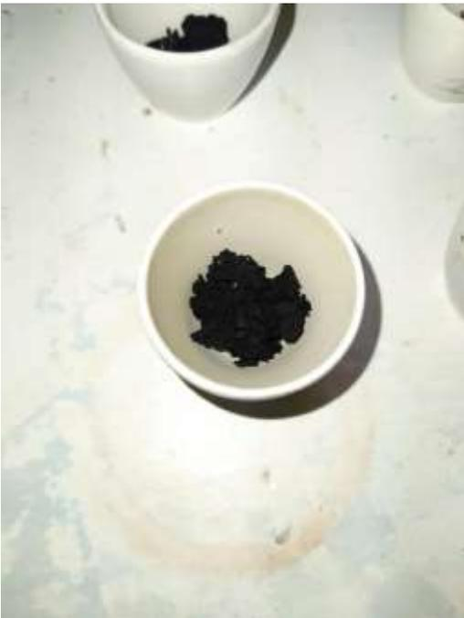
**Figura 13.** Lignina despolimerizada por medio de pirolisis catalítica
