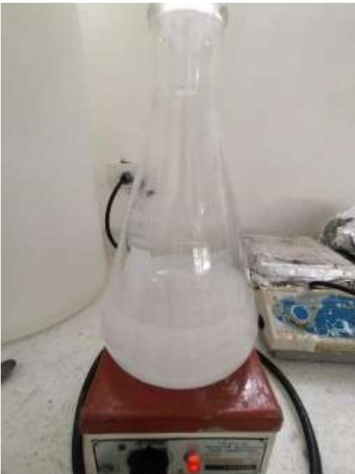
**Figura 9.** Hidróxido de sodio al 18%
