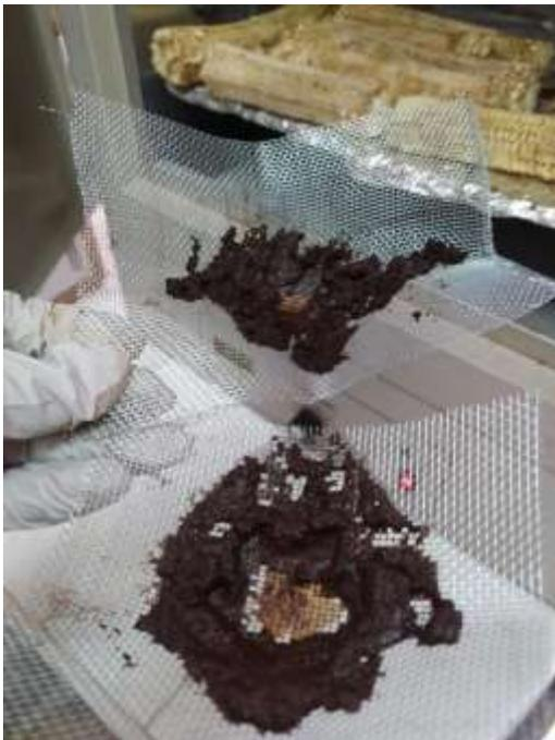
**Figura 11.** Extracto de lignina derivado de la precipitación con ácido sulfúrico 6 N
