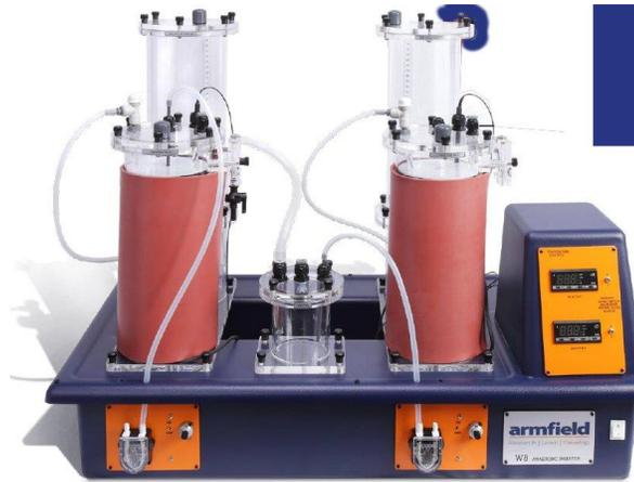
El Digestor Anaeróbico está diseñado como medio de proporcionar datos de procesos operativos para propósitos de diseño de plantas.
