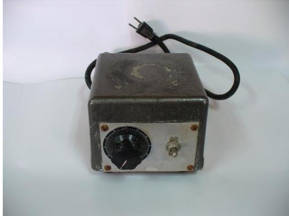
La utilización de este aparato es de agitar soluciones acuosas mediante imanes.
