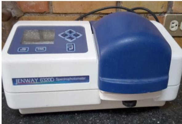
Se utiliza este **espectrofotómetro** para análisis de fotometría, concentración
