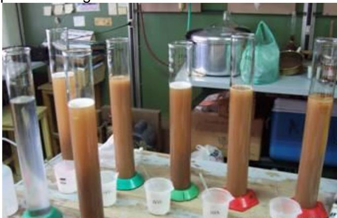
Agitar el contenido de la probeta con un agitador manual por espacio de un minuto retirar el agitador y sumergir el hidrómetro, pasados 40 segundos tomar la primera lectura ( $L_1$ ) y la temperatura ( $T_1$ ) **Terminada esta operación no mover la probeta.**
