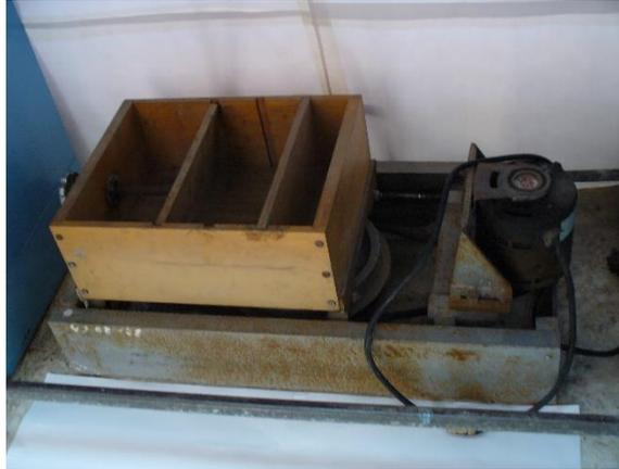
La utilización de este aparato es para agitar muestras de suelo para la determinación de potasio, también se utiliza para agitar otros materiales en solución acuosa.
