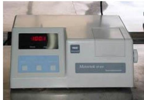
Antes de empezar a leer se ajusta el fotocolorímetro a 100% de transmitancia con un testigo que se trata exactamente igual que el suelo, solo que en lugar de la muestra de suelo usamos 1 ml. de solución de nitrato de sodio.
