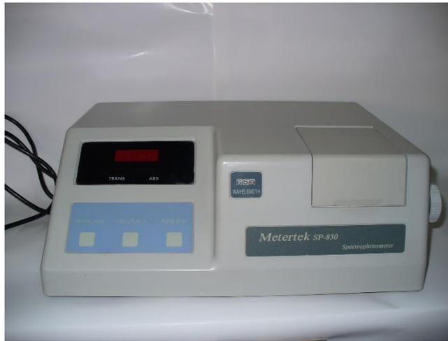
La utilización de este aparato es para medir la intensidad de colores por medio de filtros y longitudes de onda.
