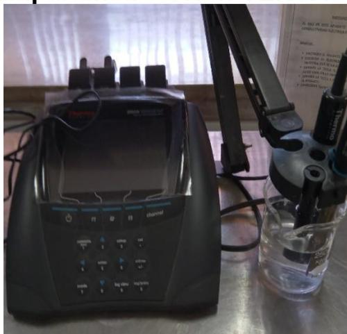
La utilización de este aparato es para la determinación de pH o C.E. en soluciones acuosas.
