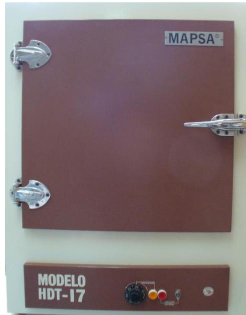
La utilización de este aparato es para secar muestras de suelo, de material orgánico o de cualquier otro material que se necesite.
