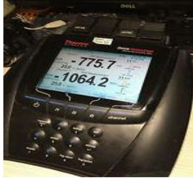
Se sumerge la celda en la solución que se va a medir y se espera a que se estabilice la lectura, el aparato nos indicará las unidades.
