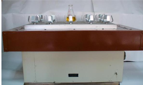
La utilización de este aparato es para agitar las muestras de suelo, agua o cualquier otra solución acuosa. Especialmente en las determinaciones de fósforo y carbonatos totales en el suelo.
