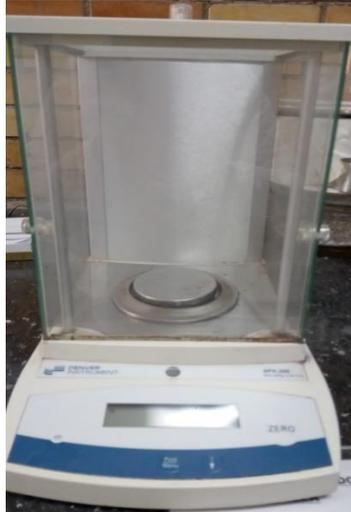
La utilización de la balanza es para hacer pesadas muy exactas de reactivos para preparar las soluciones necesarias, para cada una de las determinaciones que se hacen en el laboratorio.
