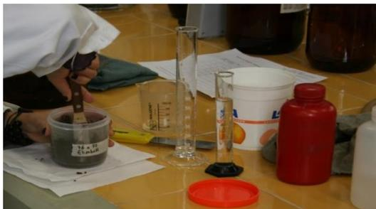
Se pesan 300 gr de suelo tamizado en malla de 2mm, se ponen en un vaso se le agrega agua destilada mezclando muy bien, hasta formar una pasta saturada, esto significa que se deslice fácilmente el suelo de la espátula y que en la parte superior del vaso se forme un espejo .
