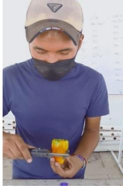
**Figura 3.** Medición del ancho de frutos, en la cual se utilizó un vernier steren<sup>MR</sup> en el laboratorio del campo experimental de la UAAAN Saltillo.
