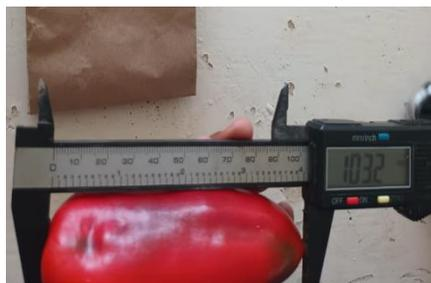
**Figura 2.** Medición del largo de frutos, en la cual se utilizó un vernier esteren<sup>MR</sup> en el laboratorio del campo experimental de la UAAAN Saltillo.
