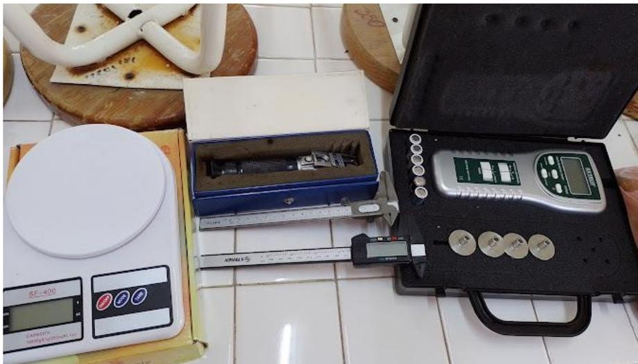
*Ilustración 6. aparatos utilizados para medir DE, DP, F(N), GB y peso del tomate. (Sandra,2021)*
