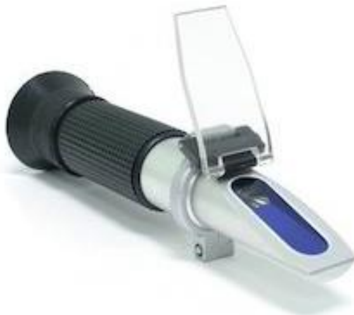
Figura 10. Refractómetro tipo manual para determinar los grados Brix del fruto.
