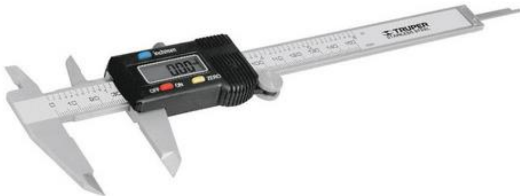
Figura 9. Vernier Digital para determinar el diámetro polar.
