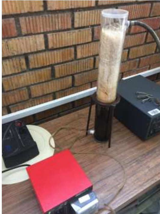
Figura 7. Llenado del reactor con fibra de Agave sisalana y lodos anaerobios.
