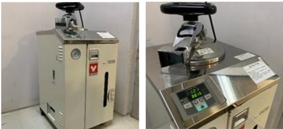
**Figura 13.** Autoclave para esterilizar los medios de cultivo.
