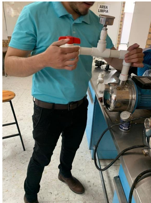
Figura 9 Armado del sistema de control de caudal parte 2
