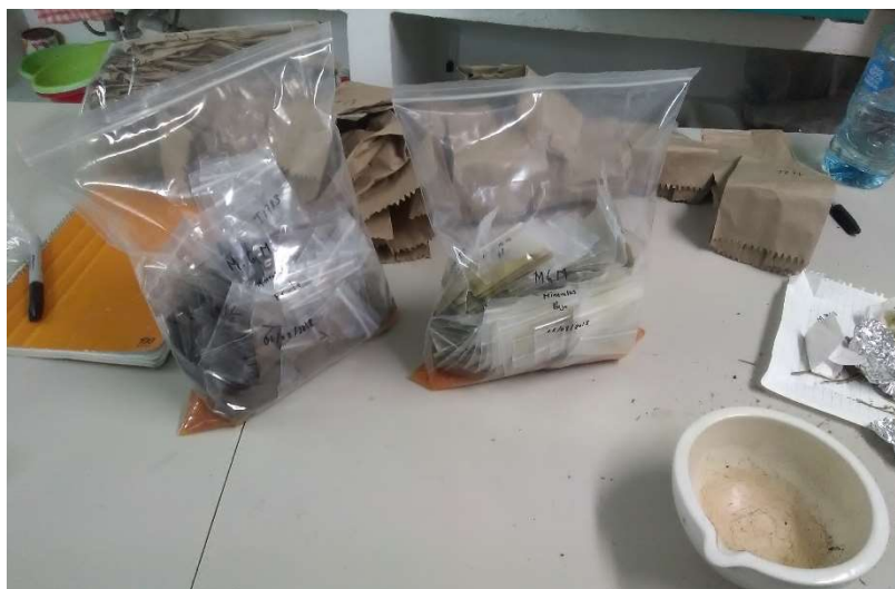
Figura 2. Muestras de material vegetal molidas en mortero y guardadas en bolsas para su análisis de As.
