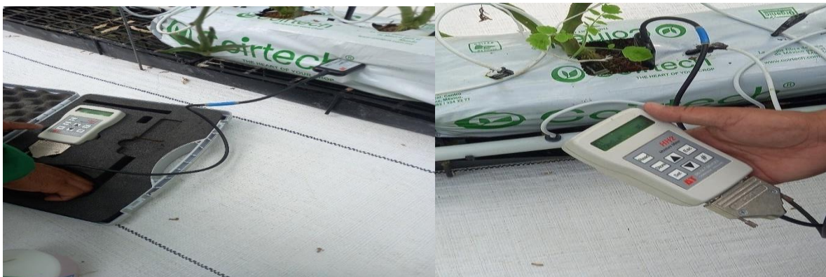
Figura 28 Sensor Wet para medición de humedad de boli
