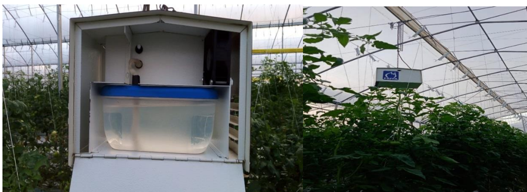
Figura 30 Cajas de mediciones de condiones climáticas dentro de invernadero
