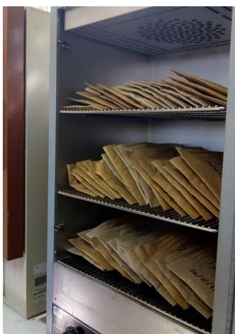
Figura 6. Secado de muestras por 24h a 65 °C
