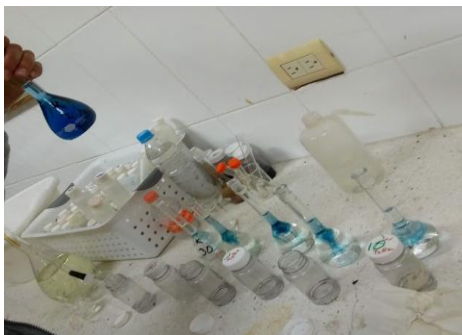
Figura 9. Muestra con solución de molibdato y disolución reductora
