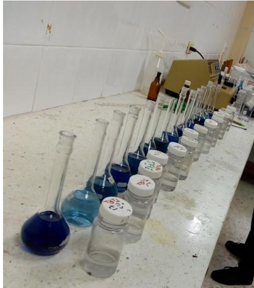
Figura 10. Medición de fosforo por espectrofotometría
