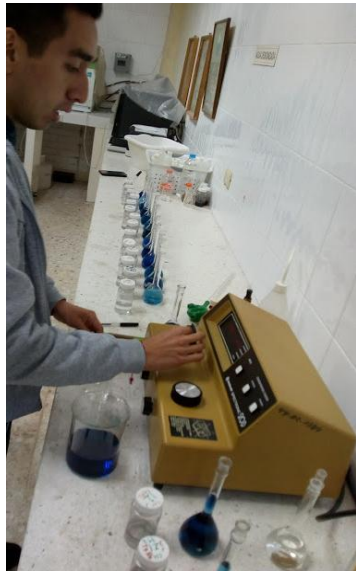
Figura 10. Medición de fosforo por espectrofotometría
