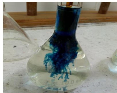
Figura 9. Muestra con solución de molibdato y disolución reductora
