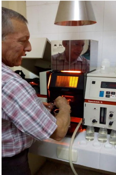
Figura 8. Medición de los metales por absorción atómica
