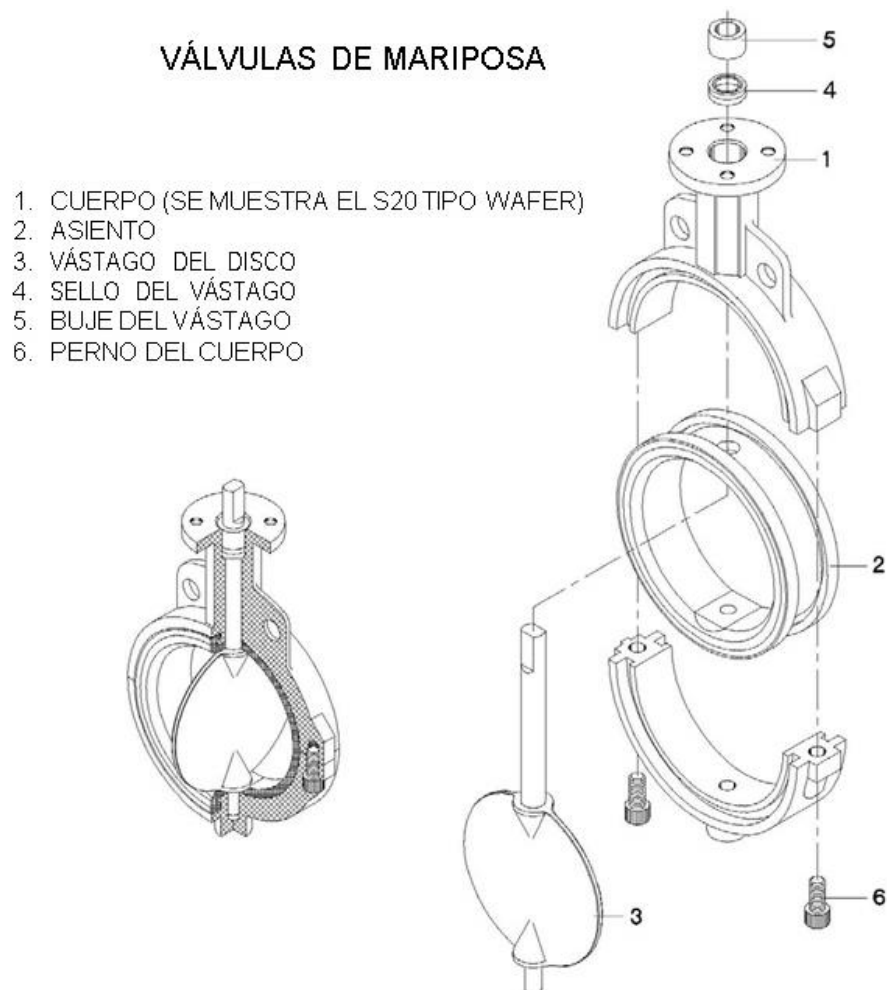
Figura 4.13 Componentes de una válvula mariposa.
