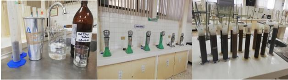
Figura 9. Determinación de la textura del suelo en laboratorio por el procedimiento de Bouyoucos.
