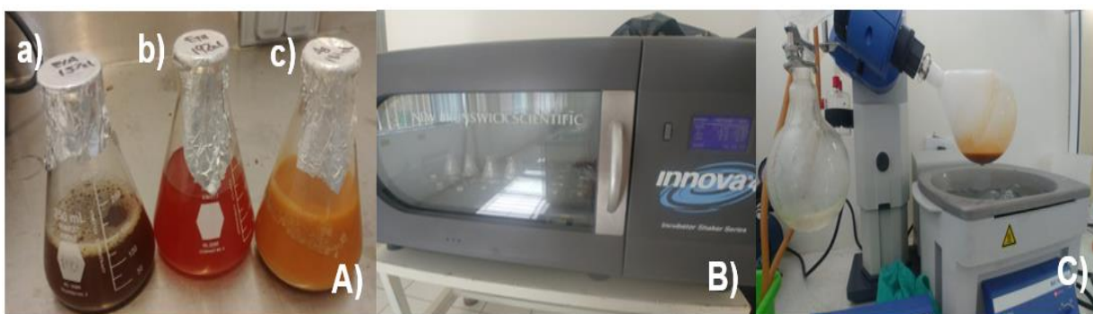
Figura 10. Proceso de preparación de extractos: A) disolución de materia seca en los solventes a) EHA- hidroalcohólico, b) EE- etanólico y c) EA- acuoso; B) homogenización de mezclas; C) eliminación de solventes por arrastre de vapor.
