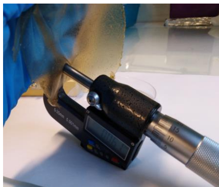
Figura 18. Lectura de espesor de película funcionalizada con extracto de R. microphylla con un micrómetro digital (No. 293-5, Mitutoyo, Japón).
