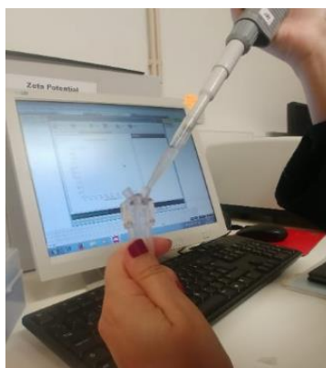
Figura 15. Evaluación de potencial zeta de recubrimientos funcionalizados en lector de microelectroforesis (Zetasizer nano ZS-90, Malvern Instruments, UK).
