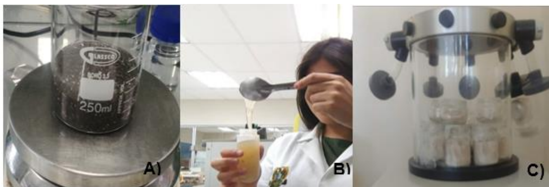
Figura 13. Proceso de obtención del mucílago de chía: A) hidratación de la semilla; B) mucílago de chía obtenido por centrifugación; C) liofilización de mucílago de chía.
