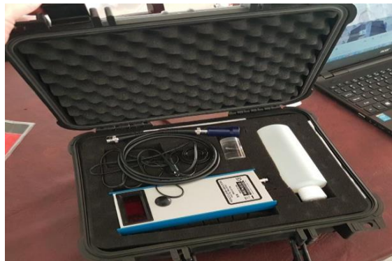
Fig. 2.10.3 Ejemplo de ultrasonido para la evaluación del espesor de la grasa dorsal en cerdas.
