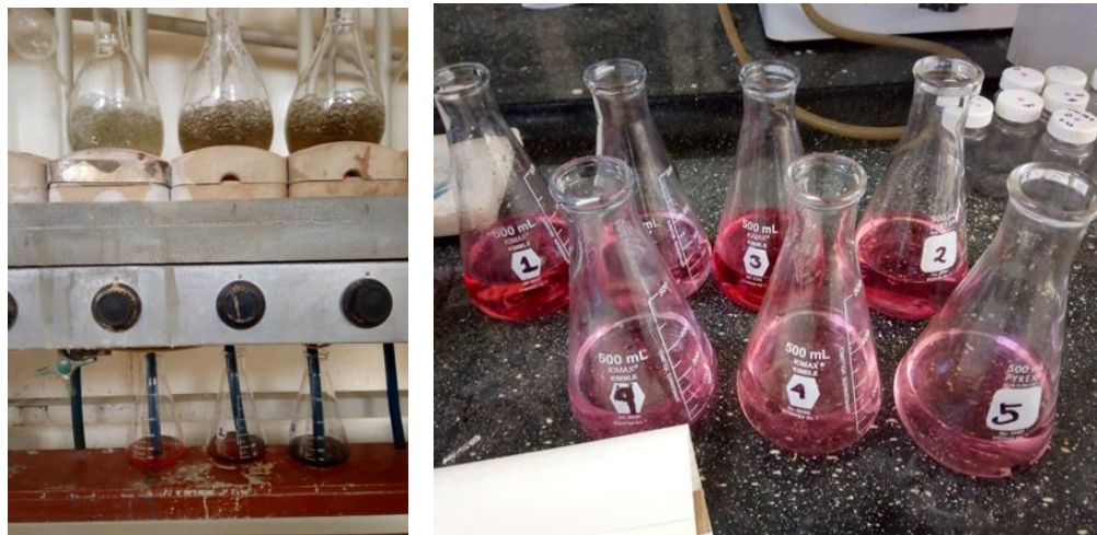
Figura 37. Determinación de proteína cruda por aparato Kjendhal de las formulaciones
