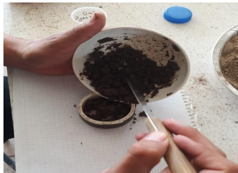
Figura 27. Llenado de la probeta con el suelo preparado
