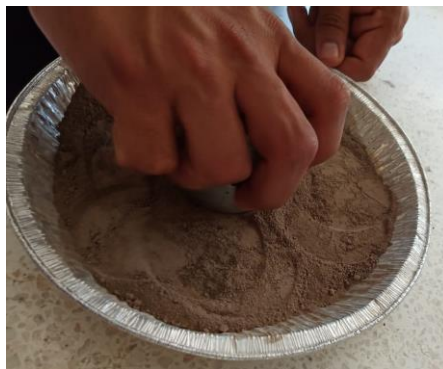
Figura 23. Deshacer los agregados
