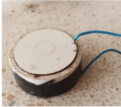
Figura 28. Probeta tapada con las tapas fenólicas
