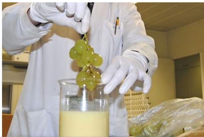
FIGURA 2. Aplicación de la película al alimento por el método de inmersión
