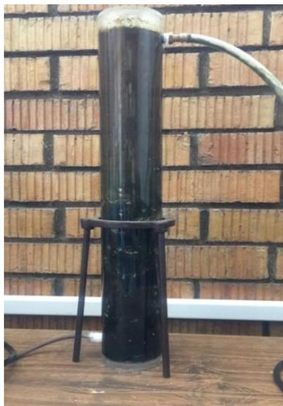
Figura 9. Reactor empacado con *Agave sisalana* después de la recirculación.
