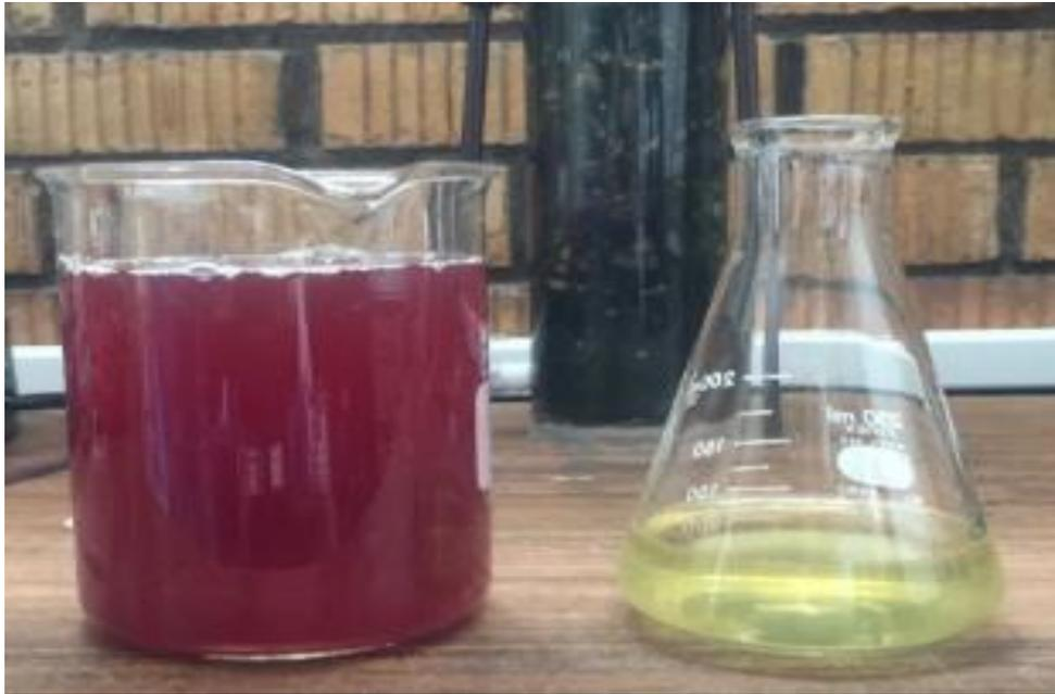
Figura 13. Agua residual del rastro sin tratamiento (izquierda) y agua residual del rastro tratada por el biofiltro usado en esta investigación (derecha).
