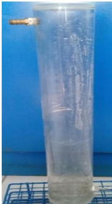
Figura 8. Reactor de acrílico utilizado en esta investigación.
