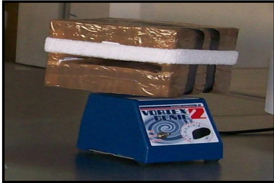
Figura 17. Agitación con equipo Vortex Genie 2
