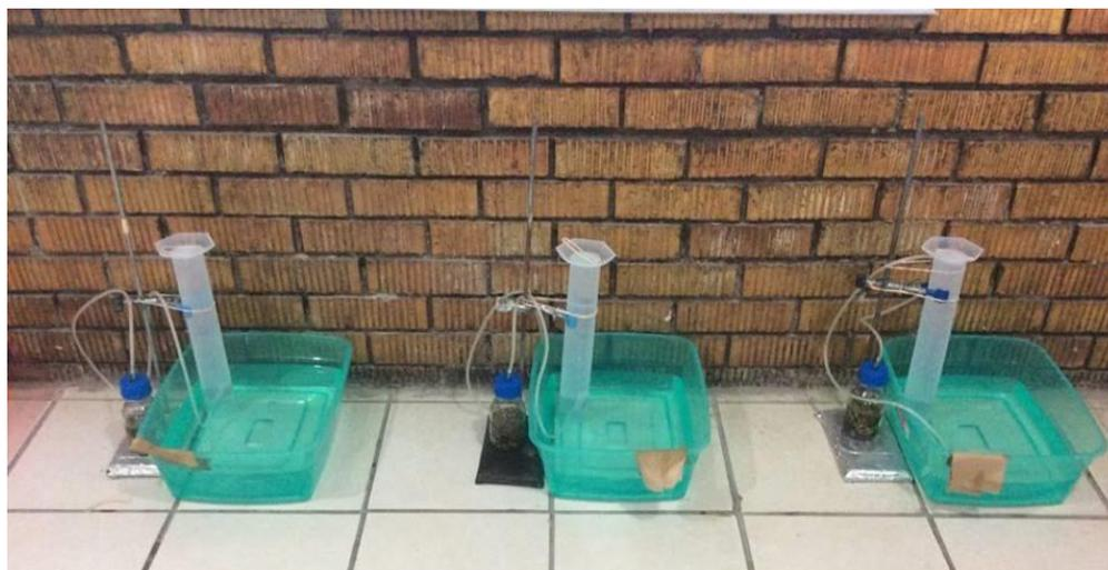
Figura 3. Biodigestores conectados al sistema para medir volumen de biogás generado.
