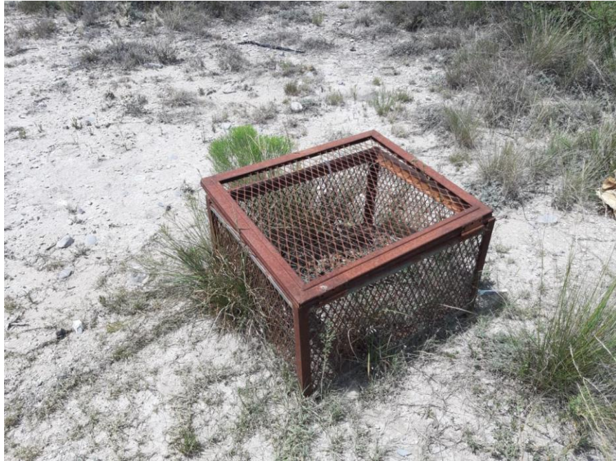
Figura 5. Jaula metálica utilizada, la parte superior tiene bisagras para poder abrirla
