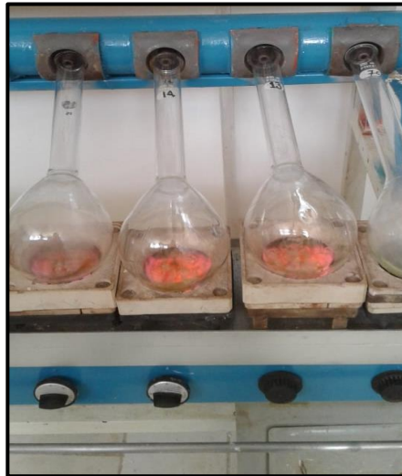
Figura 20. Matraces en aparato Kjeldhal
