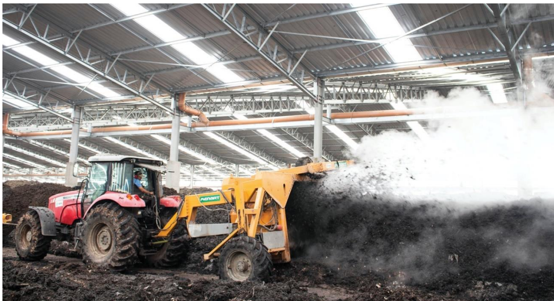
Figura 4 La empresa Tera Ambiental (Brasil), es capaz de manejar y remover material para compostaje en hileras o pilas estáticas aireadas con capacidad de 90,000 t año-1
