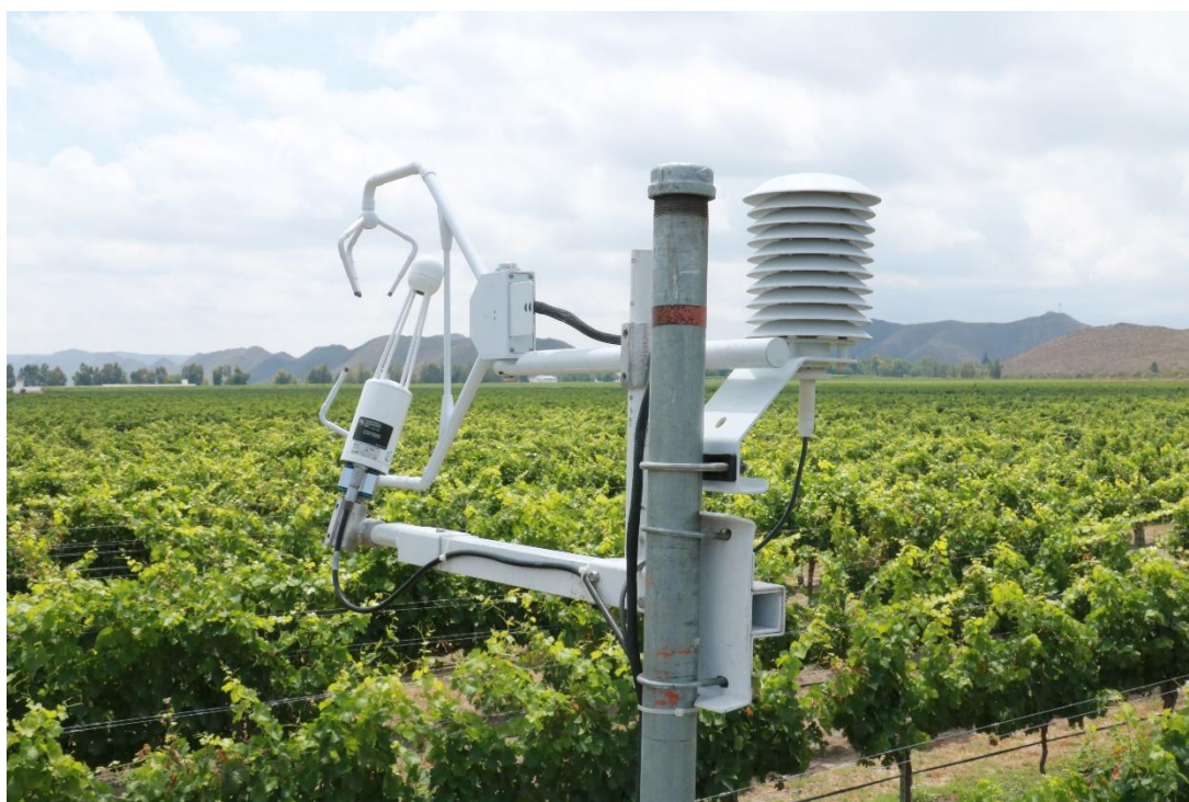
Figura 3. Sensores de un sistema eddy para la medición del flujo de bióxido de carbono entre el dosel del viñedo y la atmósfera. Ciclo de producción 2018. Vinícola San Lorenzo, Parras, Coahuila.
