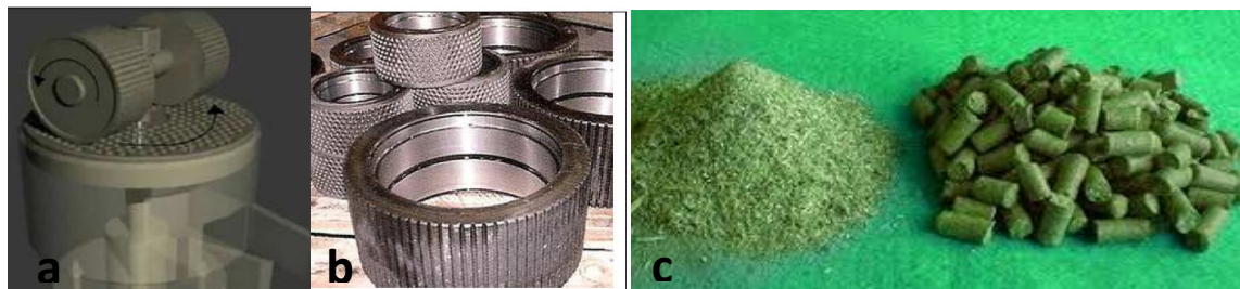
Figura 2.3.- El punto de contacto entre el dado y el rodillo (a), las características de la superficie del rodillo: corrugado o dentado (b) y las propiedades físicas de la masa a peletizar (c) determinan en conjunto la cantidad de fuerza requerida para lograr el proceso de extrusión.
