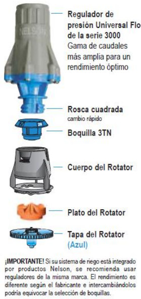
Figura 5. 2 Componentes del rotor R3000 y aspersión según el color del plato
