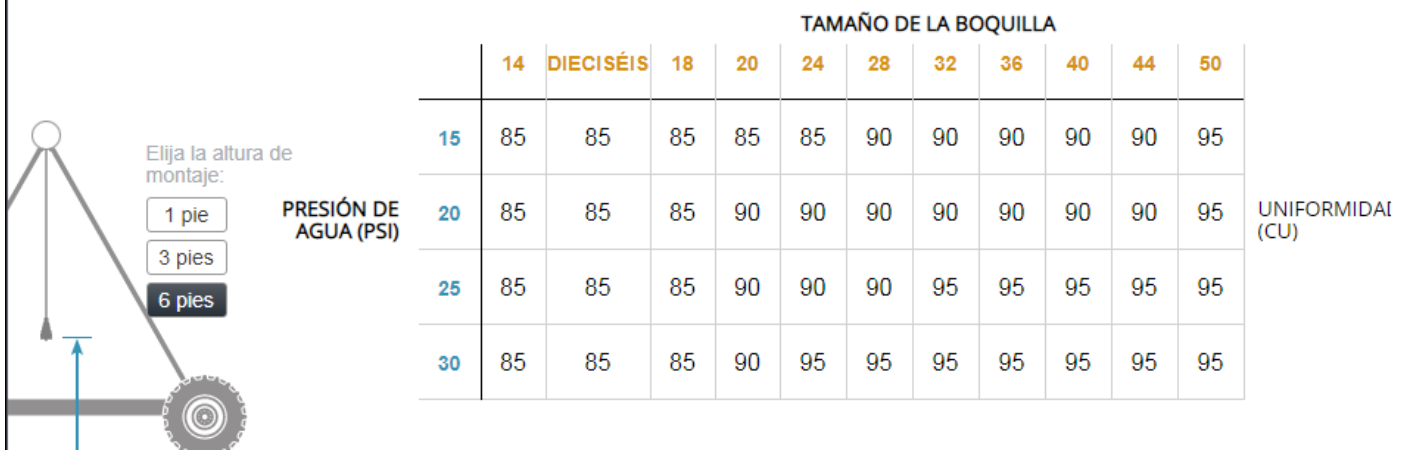
Figura 6. 5 Uniformidad de riego que la empresa ofrece por tamaño de boquillas a 6 pies de altura en diferentes presiones
