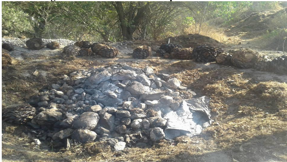
Figura 7. Calentamiento de las piedras en el horno.
