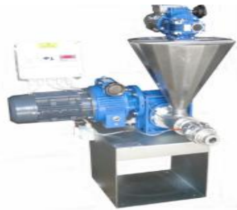
Figura 4. Extracción por prensado en frío ( www.prensadoenfrio.com )
