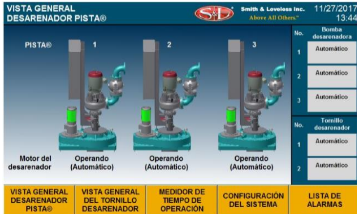
Fig. 15 Monitor general de desarenadores tipo Vortex.
