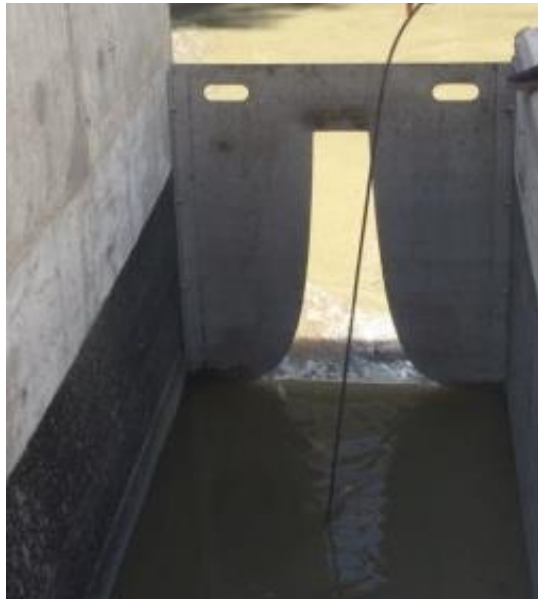
Fig. 17 medición manual de caudal por vertedero SUTRO.
