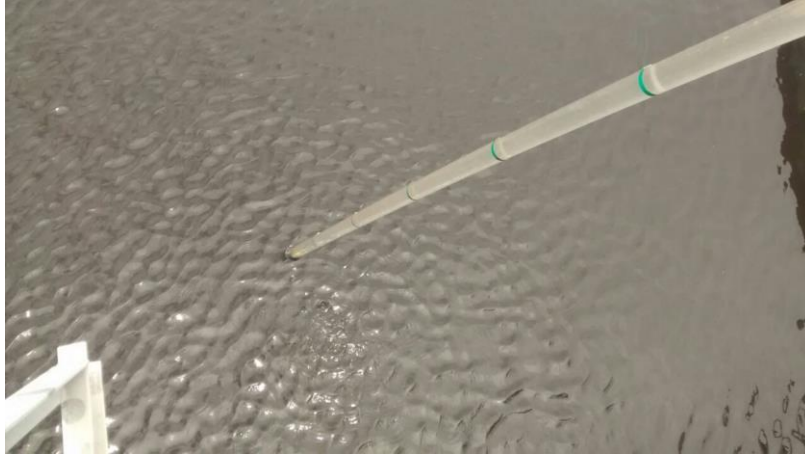
Fig. 26 Ejemplo de prueba de Colchón de Lodos.
