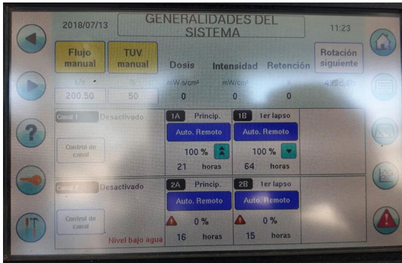
Fig. 63 Pantalla del sistema de desinfección UV.
