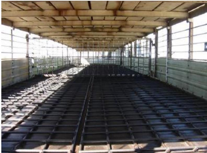
Figura 6. Piso anti-derrapante de camión (Hernández, G. 2015).
