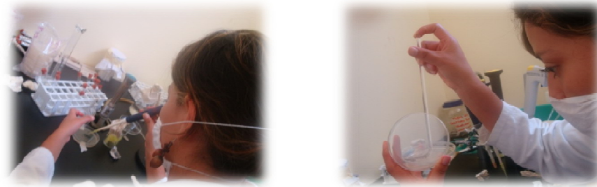
Fig. 3.7. Método de siembras de las diluciones de las muestras del queso.
