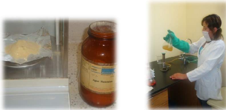
Fig. 3.1. Pesaje y preparación del agar nutritivo.
