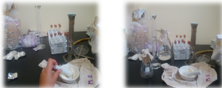
Fig. 3.5. Maceración de muestra y mezclada en 90 ml de agua estéril.
