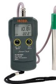
Figura 3.3 Medidor de ORP.
